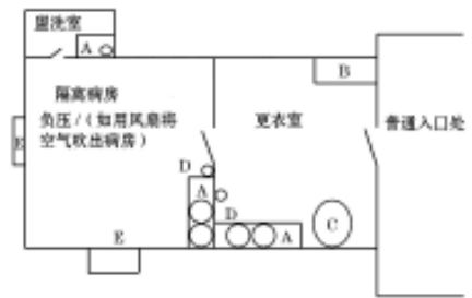
注:A消毒区域;B储存普通隔离衣和干净的个人防护用品;C放置个人防护用品的生物危险袋;D安装在墙上的酒精洗手设备;E仅能朝外排气的窗户,保持干净
